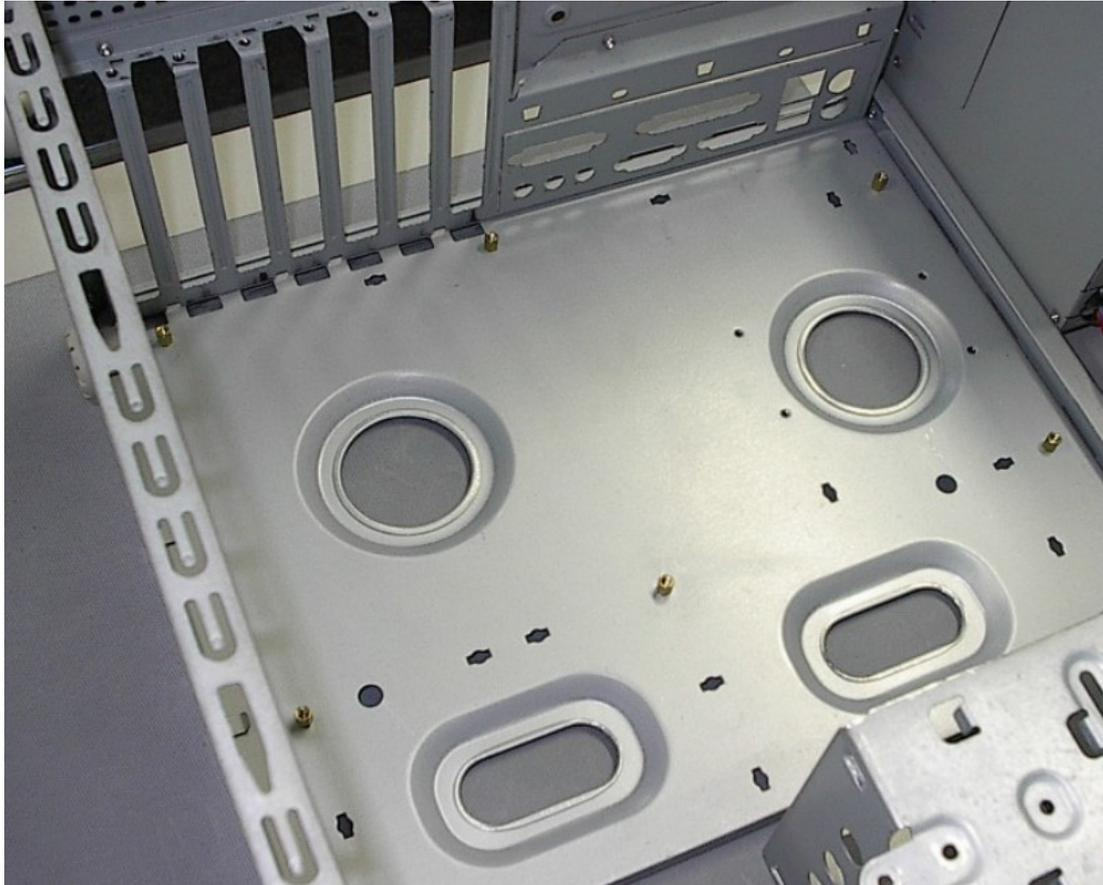
**Abrir as laterais do Gabinete e inserir os Parafusos de fixação**
